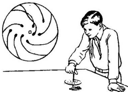
Fig. 42. Así corren las gotas de tinta por el cartón giratorio.
